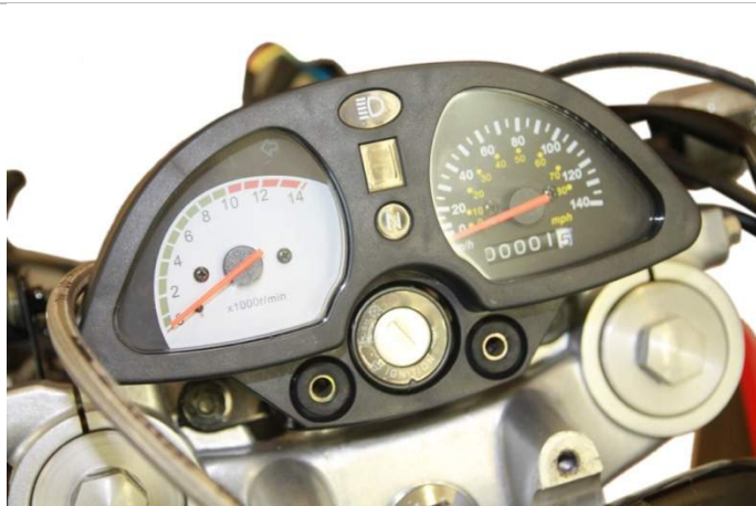
3.2.1. Устанавливаем панель приборов на кронштейн крепления.
