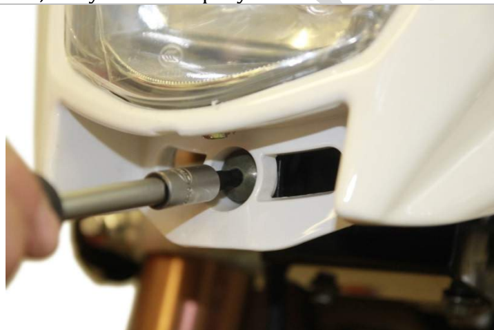
3.6.6. Закручиваем ранее выкрученный винт в лицевой части крепления пластика.
