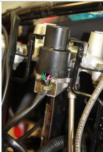
3.1.2. Фиксируем его с помощью двух болтов М10 из комплекта крепежа.
