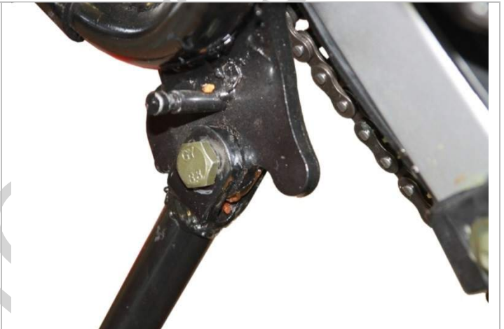
3.12.1. С помощью болта установки бокового упора фиксируем боковой упор в точке его крепления.
