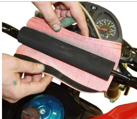
3.3.5. Установите чехол на поролоновую защиту, установленную на перекладине руля.
