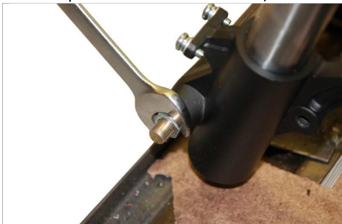
3.8.1. Открутите транспортировочную гайку осевого болта переднего колеса с помощью ключа на 19мм.
