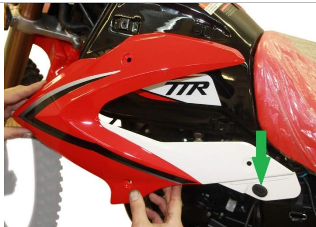
3.15.3. Устанавливаем пластик бака так, как указано на рисунке.
