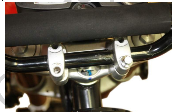
3.3.2. Установите две верхние части хомута крепления руля в соответствии с рисунком. Наживите болты крепления.
