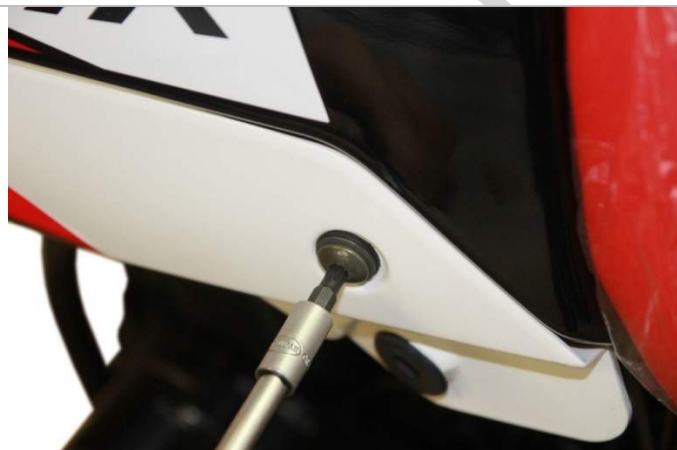
3.15.5. Закручиваем винты крепления пластика бака.
