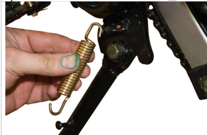
3.12.2. Устанавливаем пружину бокового упора. Для этого сначала закрепляем ее в верхней точке крепления, расположенной на раме мотоцикла, а затем натягиваем ее на нижнюю точку крепления, расположенную на боковом упоре.
