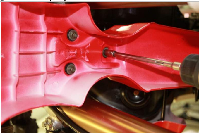
3.8.7. Закручиваем болты крепления переднего крыла.
