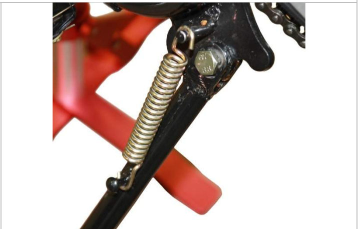
3.12.2. Устанавливаем пружину бокового упора. Для этого сначала закрепляем ее в верхней точке крепления, расположенной на раме мотоцикла, а затем натягиваем ее на нижнюю точку крепления, расположенную на боковом упоре.
