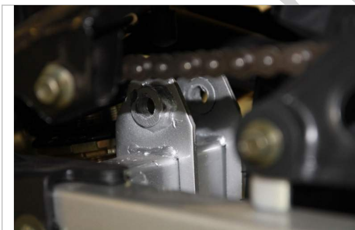
3.7.1. Для установки в рабочее положение маятника задней подвески используем болт крепления маятника задней подвески с гайкой, идущих в комплекте поставки. Заднюю часть мотоцикла необходимо поднять так, чтобы отверстие на кронштейне амортизатора совпало с отверстием на заднем маятнике (выделено стрелкой). Устанавливаем болт и фиксируем его гайкой (для этой операции необходим помощник).
