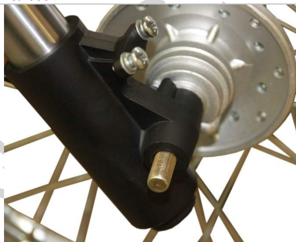
3.9.1. Полностью установите осевой болт крепления колеса.
