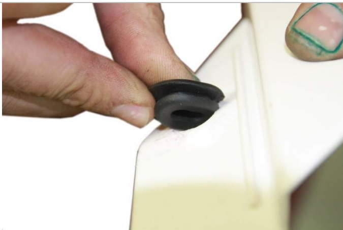
3.15.2. Устанавливаем резиновую манжету из комплекта крепежа (место ее установки указано на рисунке 3.15.3. зеленой стрелкой).
