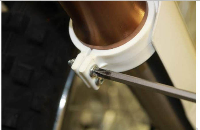
3.11.7. Закручиваем винты хомута крепления защиты передних амортизаторов.
