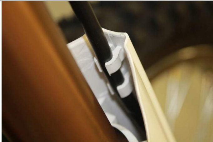
3.11.6. Внутри пластиковой защиты с правой стороны мотоцикла закрепляем трос привода спидометра так, как указано на рисунке.
