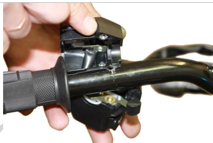
3.4.2. Разводим две половины левого блока переключателей в разные стороны, одеваем на руль и сводим обратно так, как показано на рисунке.
