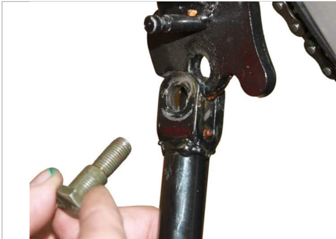
3.12.1. С помощью болта установки бокового упора фиксируем боковой упор в точке его крепления.
