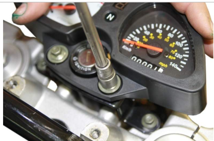
3.2.3. Затягиваем болты крепления.
