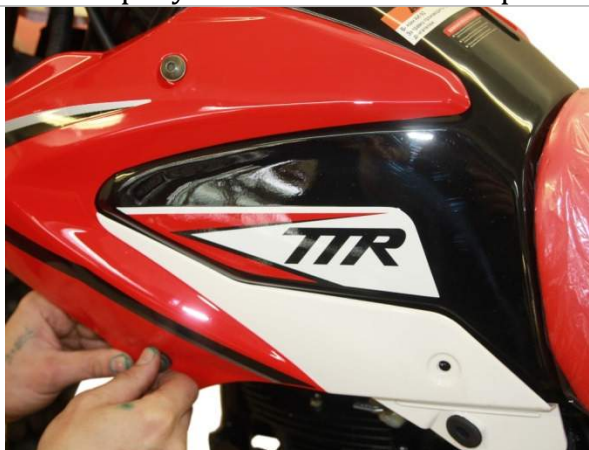
3.15.4. Фиксируем пластик ранее выкрученными винтами.
