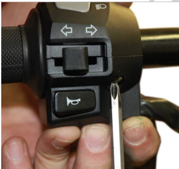
3.4.3. С помощью ранее выкрученных винтов фиксируем вместе две половины левого блока переключателей. С помощью крестовой отвертки закручиваем болты крепления.
