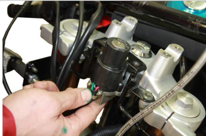
3.1.1. Устанавливаем замок зажигания в кронштейн крепления так, как указано на фото.
