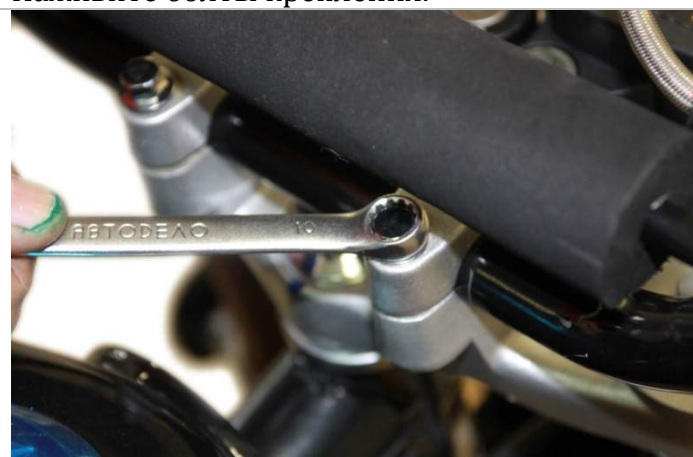
3.3.4. Отрегулировав руль в нужное положение, закрутите болты крепления.
