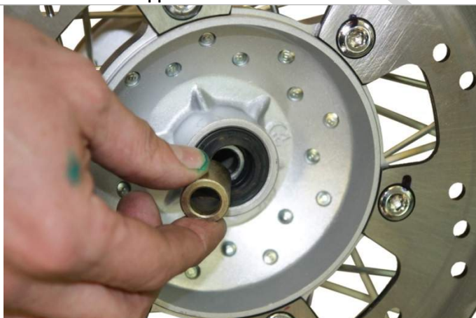
3.9.1. В диск переднего колеса с левой стороны мотоцикла установите втулку.
