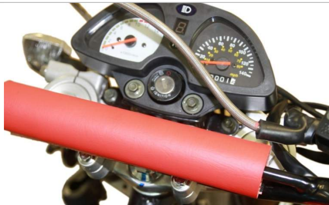
3.3.5. Установите чехол на поролоновую защиту, установленную на перекладине руля.
