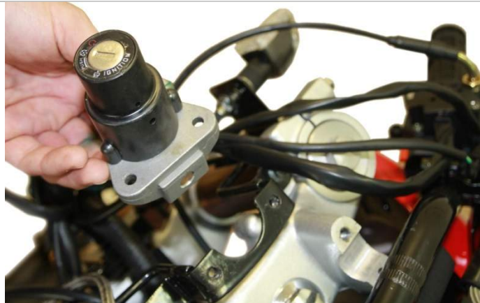
3.1.1. Устанавливаем замок зажигания в кронштейн крепления так, как указано на фото.
