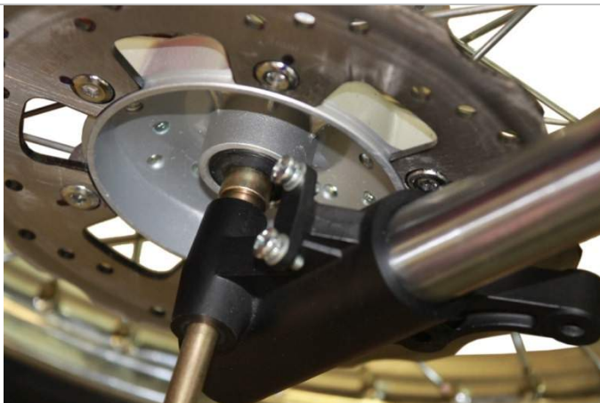
3.9.1. Наполовину вставьте осевой болт с левой стороны мотоцикла.
