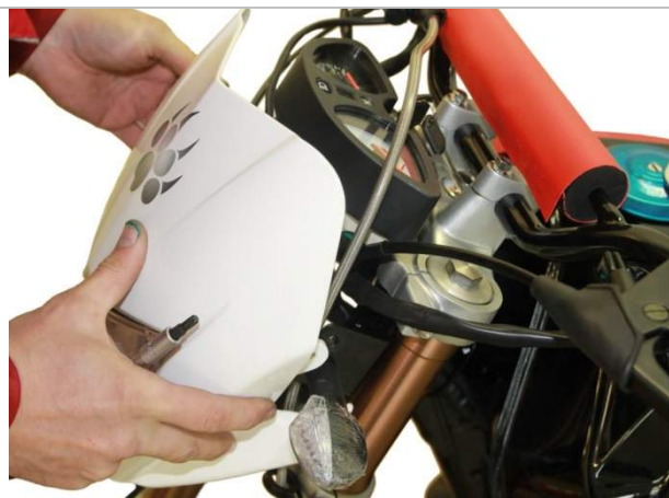
3.6.4. Устанавливаем передний пластик с фарой так, как указано на рисунке.
