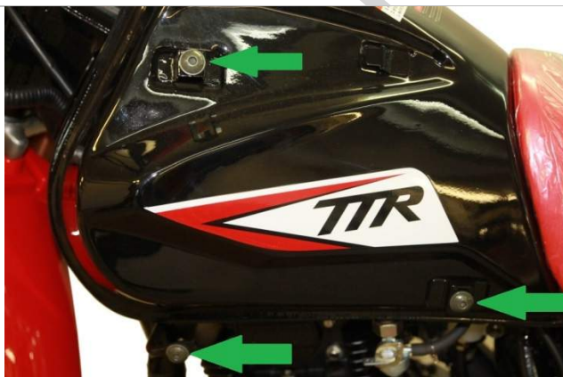
3.15.1. Откручиваем три винта крепления пластика бака.
