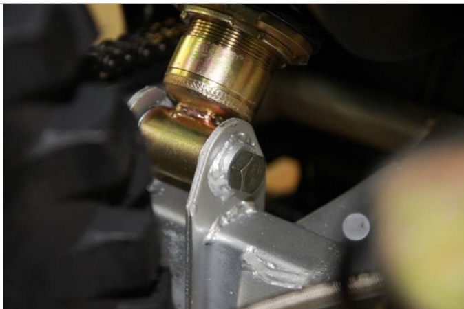
3.7.2. Затяните болт крепления заднего амортизатора.
