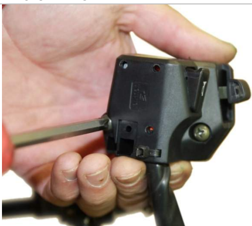
3.4.1. С помощью крестовой отвертки с нижней части левого блока переключателей выкручиваем два винта.
