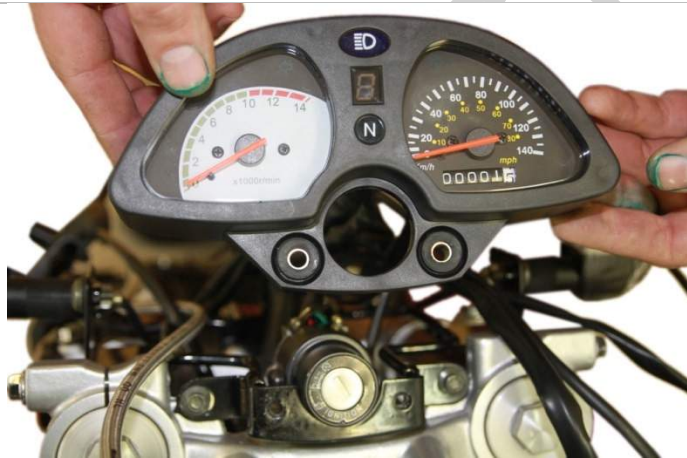
3.2.1. Устанавливаем панель приборов на кронштейн крепления.
