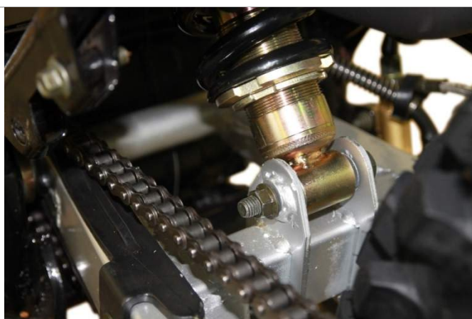
3.7.1. Для установки в рабочее положение маятника задней подвески используем болт крепления маятника задней подвески с гайкой, идущих в комплекте поставки. Заднюю часть мотоцикла необходимо поднять так, чтобы отверстие на кронштейне амортизатора совпало с отверстием на заднем маятнике (выделено стрелкой). Устанавливаем болт и фиксируем его гайкой (для этой операции необходим помощник).
