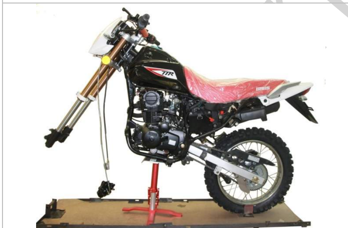
3.8.3. Поднимаем переднюю часть мотоцикла и устанавливаем его на упор (для этого необходим помощник).
