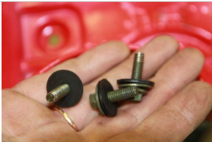
3.8.5. Подготавливаем болты. Одеваем на них металлические и резиновые шайбы так, как указано на рисунке.
