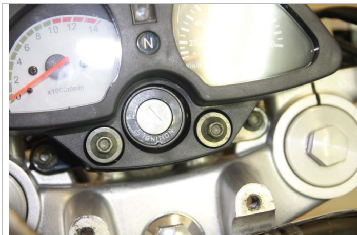
3.2.2. Фиксируем с помощью двух болтов М8 из комплекта крепежа.
